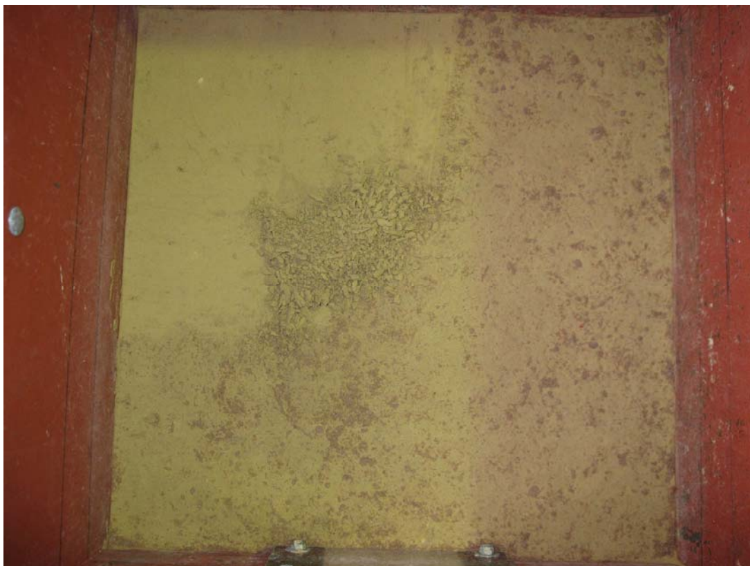
Abb. 9: Trennschicht des Versuchs 3 während des Ausbaus
